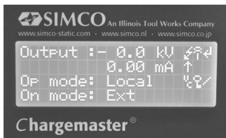
In het hoofdscherm van de generator worden de actueel gemeten spanning en stroom weergegeven alsook de operationele mode. Teksten worden aan de linkerzijde van het display weergegeven, de symbolen aan de rechterzijde. De symbolen die betrekking hebben op een operation mode zijn op dezelfde regel als de tekst geplaatst.
