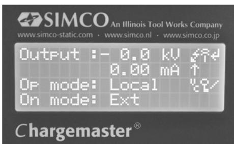
La schermata principale del generatore mostra la tensione e la corrente attuale misurate e la modalità operativa. Il testo viene mostrato sul lato sinistro del display e i simboli sul lato destro. I simboli che fanno riferimento a una modalità operativa vengono visualizzati sulla stessa linea del testo.
