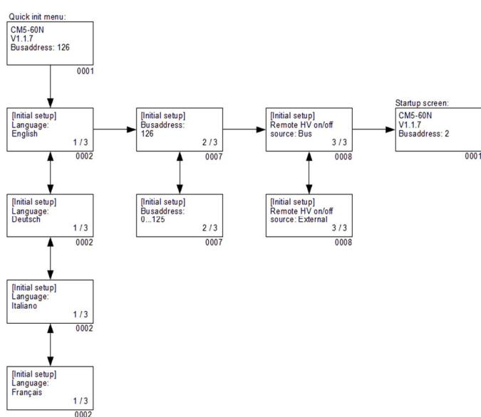
Il menu "Impostaz. iniziale" o menu di configurazione veloce viene utilizzato per configurare velocemente il generatore. Dopo la configurazione, il generatore deve essere messo direttamente in uso. Quando sul display viene visualizzato "[Impostaz. iniziale]" significa che il generatore deve ancora essere configurato per l'utilizzo.
