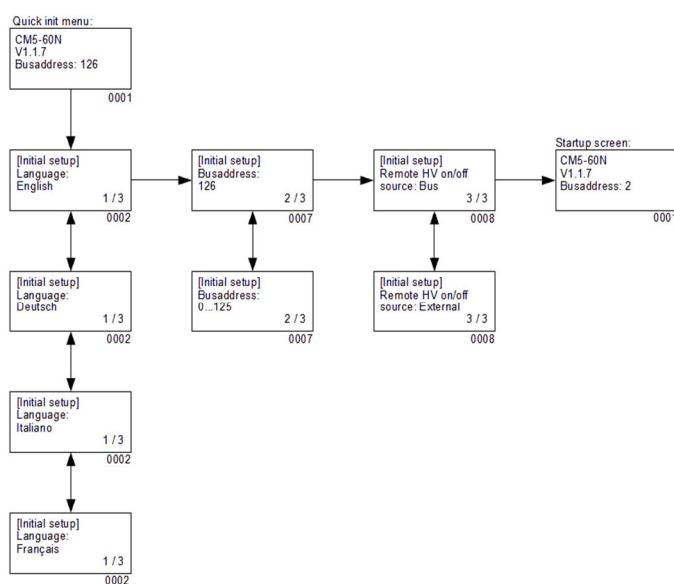
Le menu « **Initial setup** » (Configuration initiale), ou menu d'initialisation rapide, sert à configurer rapidement le générateur. Le générateur peut être utilisé immédiatement après sa configuration.
