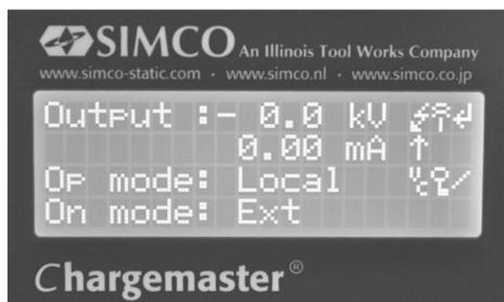
Der Hauptbildschirm des Generators zeigt die aktuell gemessenen Werte von Spannung und Strom sowie den Betriebsmodus an. Texte sind auf der linken Seite des Displays angeordnet, Symbole auf der rechten Seite. Die Symbole, die sich auf einen Betriebsmodus beziehen, werden auf derselben Zeile wie der zugehörige Text angezeigt.
