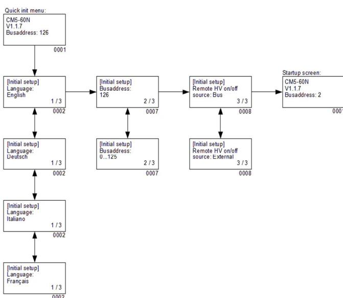
Het ‘Initial setup’ of snelle configuratie menu wordt gebruikt om de generator op een snelle manier te kunnen configureren. Na configuratie kan de generator direct in gebruik worden genomen.
