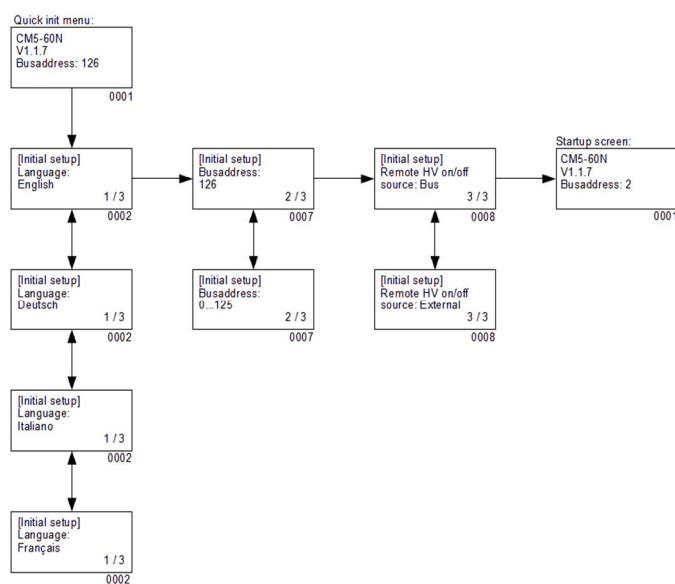
Über das Menü „Initial setup“ (Erstinstallation) bzw. die Schnellkonfiguration können Sie den Generator schnell und einfach konfigurieren. Der Generator kann nach der Konfiguration sofort verwendet werden.
