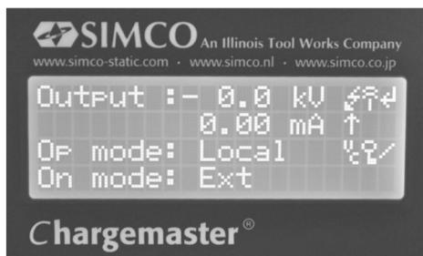
L'écran principal du générateur affiche la tension et le courant actuellement mesurés, ainsi que le mode d'utilisation. Les textes sont affichés sur le côté gauche de l'écran et les symboles sur le côté droit. Les symboles faisant référence au mode de fonctionnement s'affichent sur la même ligne que le texte.
