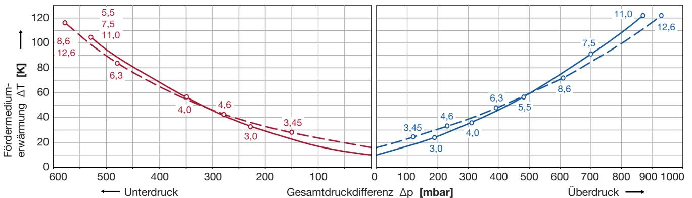
Die Kennlinien gelten für Fördermedium Luft von 15 °C und Atmosphärendruck von 1013 mbar mit einer Toleranz von  $\pm 10\%$ . Die maximal im Dauerbetrieb zulässigen Gesamtdruckdifferenzen gelten bis zu einer Ansaug- und Umgebungstemperatur von 25 °C. Bei anderen Bedingungen bitten wir um Rücksprache.
