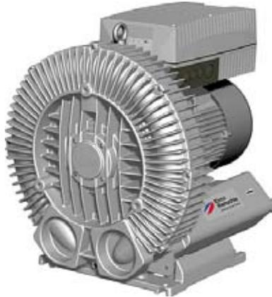
Der deutlich erweiterte Leistungsbereich mit einem Ansaugvolumenstrom bis zu 850 m³/h sowie einer Druckdifferenz bis 1.100 mbar eröffnet der Seitenkanaltechnik völlig neue Aufgabenfelder, die bisher undenkbar waren, verbunden mit einem verbesserten Wirkungsgrad und einem außergewöhnlich niedrigen Geräuschniveau. Die G-BH2 laufen problemlos 40.000 Betriebsstunden und sind dabei faktisch wartungsfrei.
