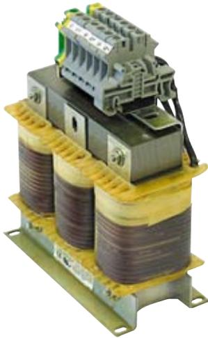
Eine Netzdrossel (IP20) ist eine Induktivität, die in die Netzleitung des Frequenzumrichters geschaltet werden kann. Sie begrenzt die Netzoberwellen, die durch das Wirkprinzip des Eingangsgleichrichters auftreten.
