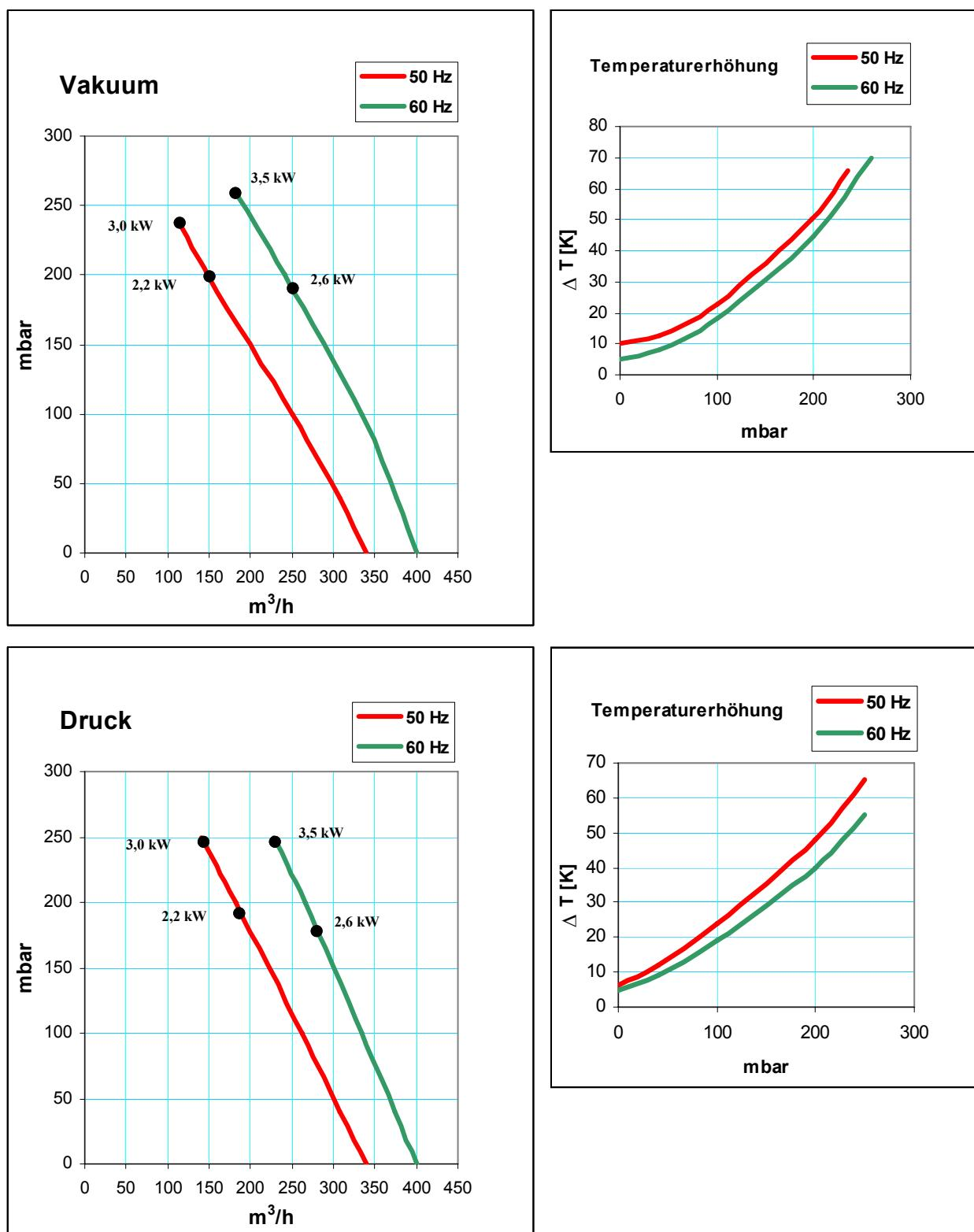
Die Kennlinien haben eine Toleranz von  $\pm 10\%$  und beziehen sich auf freie atmosphärische Luft von 1 bar (abs.) und 20°C
