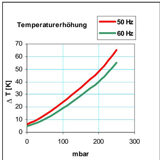
Die Kennlinien haben eine Toleranz von  $\pm 10\%$  und beziehen sich auf freie atmosphärische Luft von 1 bar (abs.) und 20°C
