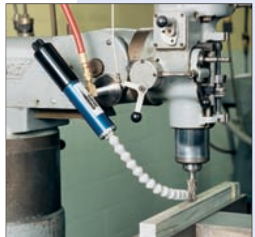
Durch Verwendung der stufenlos einstellbaren Kaltluftpistole wird die Werkzeugstandzeit erheblich verlängert.
