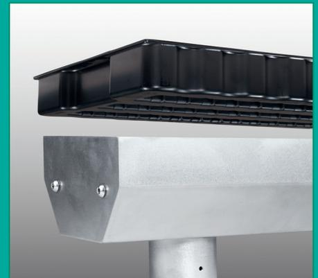
Unterseitenreinigung (z. B. Kunststoffschalen) mit ionisierter Luft und Rotationsdüsen bei gleichzeitiger Absaugung
