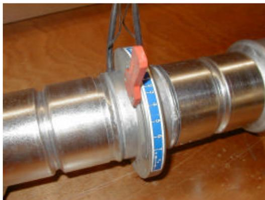
Abbildung C : Luftklappe
